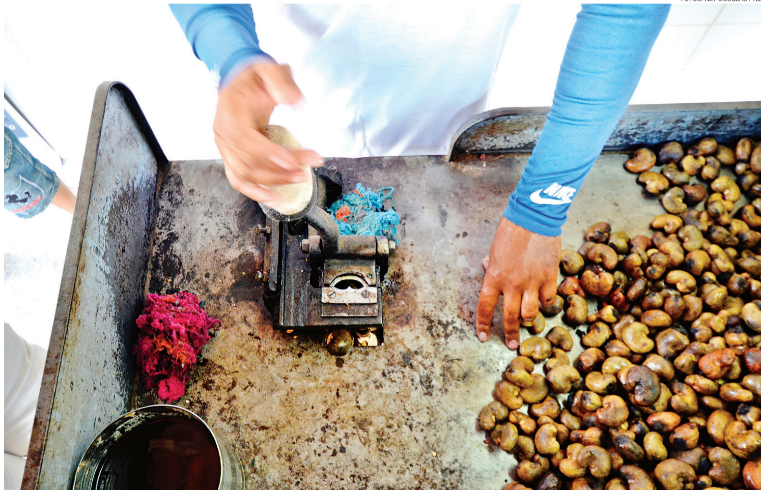
► A castanha solta um líquido corrosivo, o LCC, que fere as mãos de quem retira a sua casca; trabalho ainda é feito numa máquina manual
