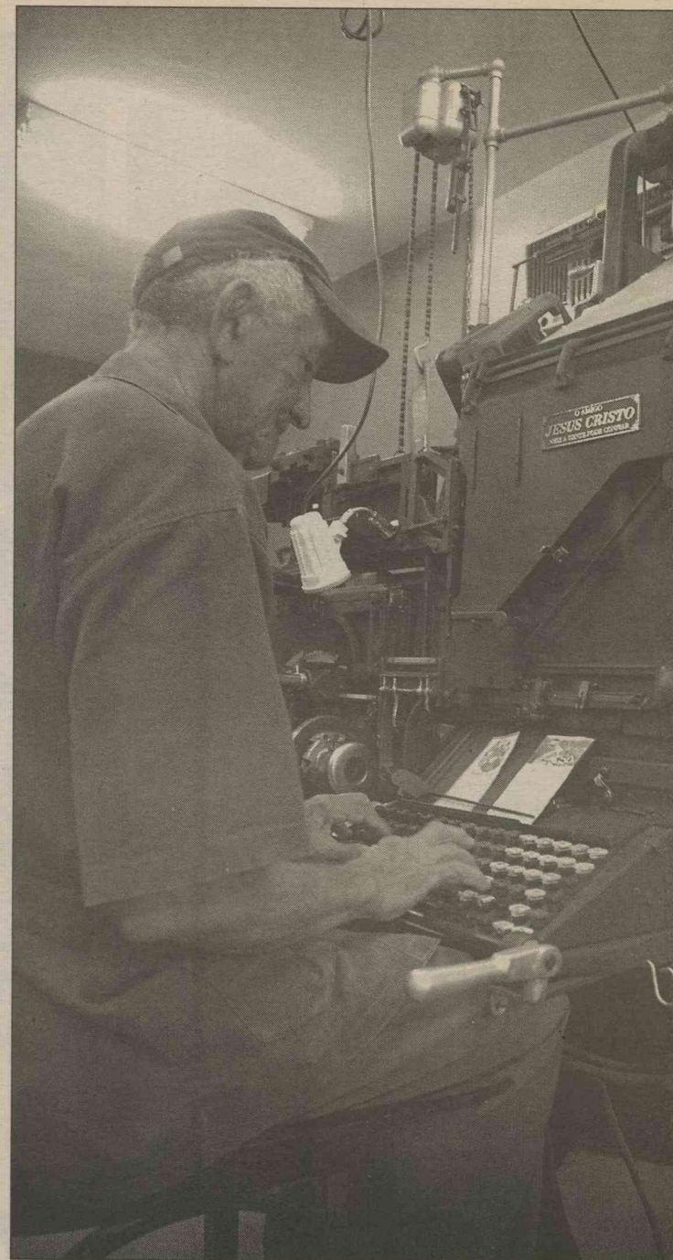
A máquina Linotype, ou linotipo, inventada por Otomoar Mergenthaler, em 1886
