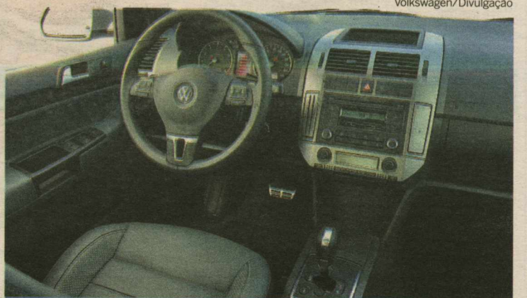
Detalhe da alavanca automatizada que dispensa o uso do pedal de embreagem
