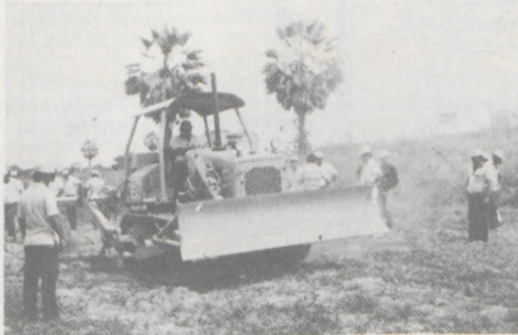
— D4E equipado com lâmina 4A, tóldo e barra porta ferramenta.
